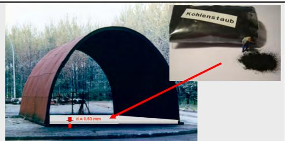
Explosionsversuch mit Kohlenstaub
