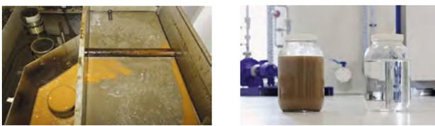
Trennemulsion aus dem Druckguss **Spülwasser** aus der Teilereinigung
