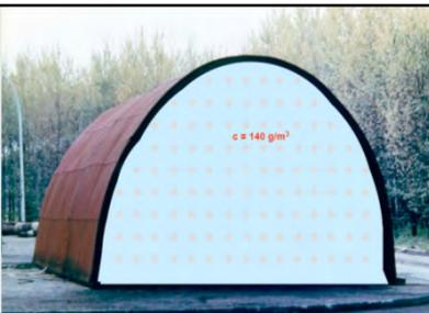
Explosionsversuch mit Kohlenstaub
