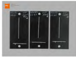
Pulverlack 20 min / 140°C
