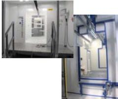
Es sind eine Pulverkabine mit Zyklon-Rückgewinnung für Automatik-/Hand-Betrieb und eine Pulverkabine zur Hand-Beschichtung auf Verlust vorgesehen.
