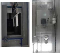
Der Pulvereinbrennofen ist mit einer DUO-Voll-Hybrid-Beheizung (Gas / elektrisch) ausgestattet.
