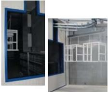
Nach dem Einbrennen der Pulverbeschichtung werden die Werkstücke in der WRG-Kühlzone abgekühlt. Die Abwärme wird dabei zurückgewonnen und zur Rücklauf-Temperatur-Anhebung verwendet.
